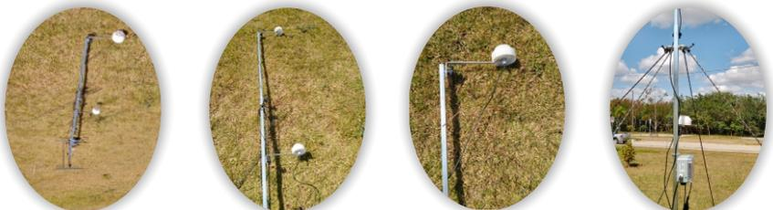
Ligue os cabos de conexão nos sensores correspondentes cabo 1 no sensor T-1 e cabo 2 no sensor T-2
