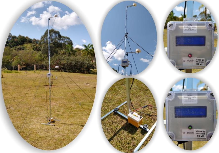
Marque quatro pontos afastados dois passos do centro da Torre para fixação das estacas de amarração das cordas (entre 1,5 a 1,6 m de afastamento), nos sentidos Norte, Sul Leste e Oeste.
