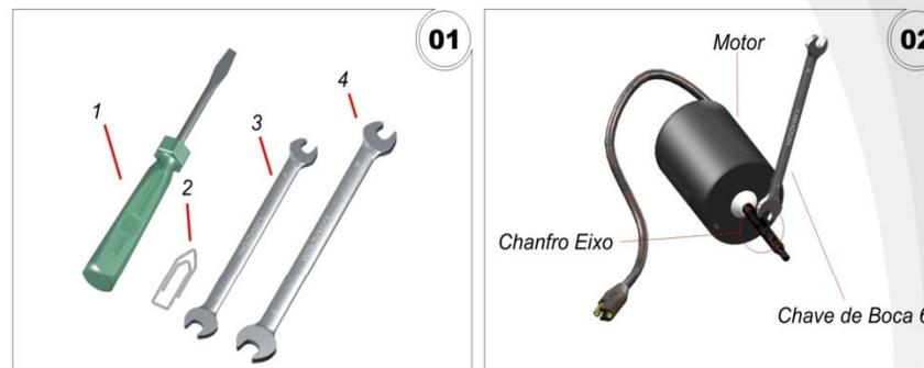
Ferramentas: 1- Chave Fenda (pequena); 2 - Clips ou qualquer objeto de diâmetro menor que 1mm; 3- Chave de Fixa 6x7mm; 4- Chave de Fixa 8x9mm.
