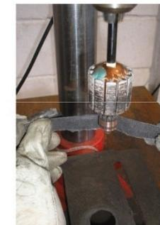
**Adaptar o eixo do motor em uma furadeira de bancada para efetuar o lixamento do induzido.**
