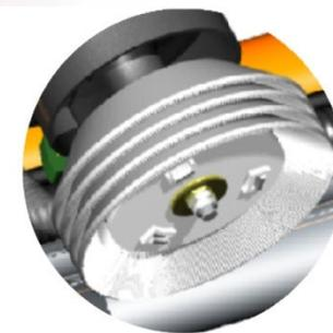
**Os discos com vibração excessiva ou sujeira excessiva, devem ser trocados por discos novos e mais rápido possível.**
